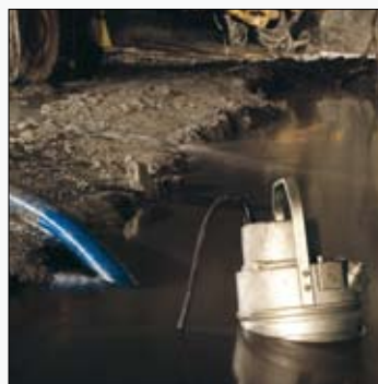
Насос Sandy в работе
